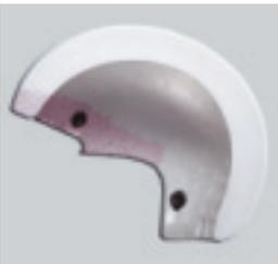
Sie besteht in der Regel aus expandiertem Polystyrol-Hartschaum (EPS), besser bekannt unter dem Oberbegriff Styropor. Sie nimmt den Großteil der Aufprall-Energie auf und verteilt die einwirkenden Kräfte gleichmäßig auf den Kopf. Zur besseren Dämpfung werden auch ein- oder mehrteilige Innenschalen mit unterschiedlichen EPS-Dichten verarbeitet.
