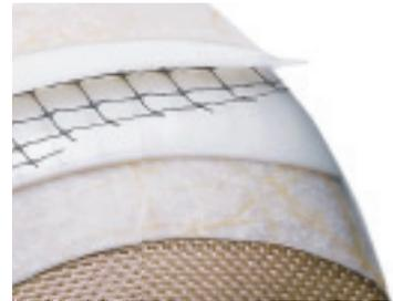
Die Oberfläche dieser Verbundwerkstoffe hält große Belastungen aus und weist eine hohe Beständigkeit gegenüber UV-Strahlung und Lösungsmitteln auf.
